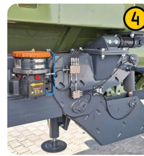
Programovatelný počítač s přesným intervalem mazání ložisek
