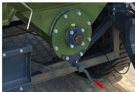
Šroubový mechanismus otevírání vodorovné čisticí klapky šneku
