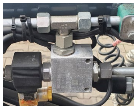
Hydraulický ventil pro blokování otevření hradítka u pevného PTO
