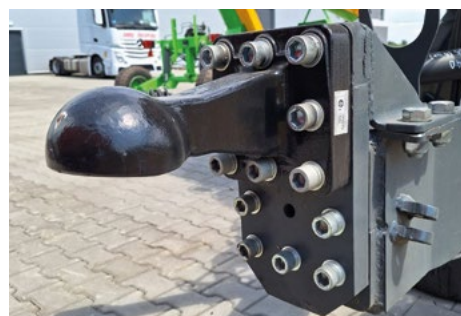
Adaptér pro nastavení výšky pro připojení k jakémukoli traktoru
