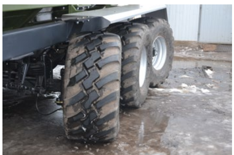
Hydraulicky ovladatelná první a poslední náprava (PBN-40 a PBN-50).
