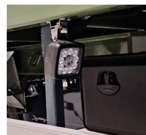
Boční a zadní LED světla pro osvětlení technologické dráhy
