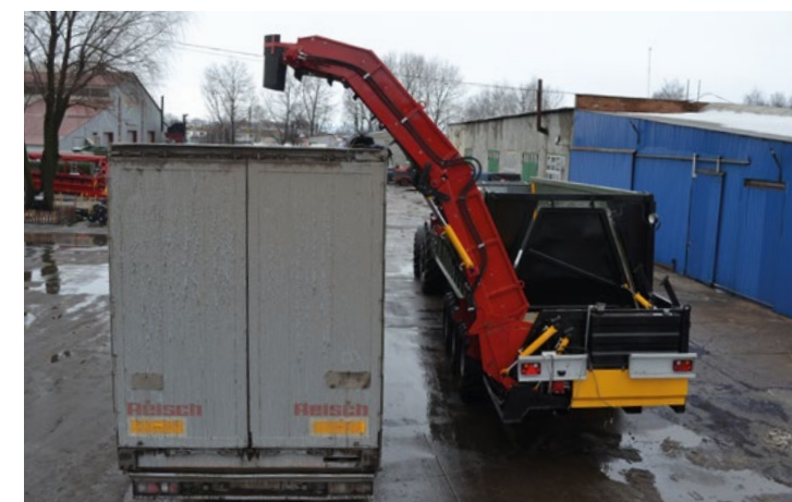
Překladač řepy do výšky 4,5m.
