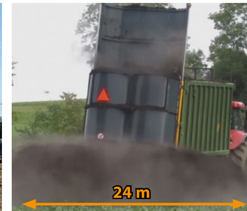
Deflektory omezení rozhozu mrvy talíři. Zavřená vrata rozmetacího adaptéru
