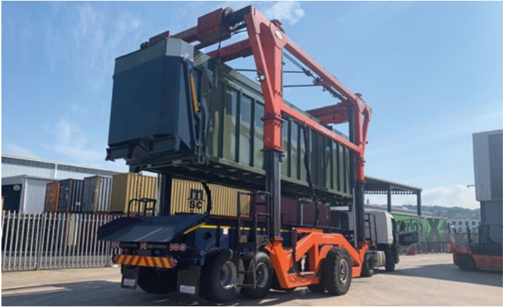
Nástavba AZP-60 namontovaná na podvozku
