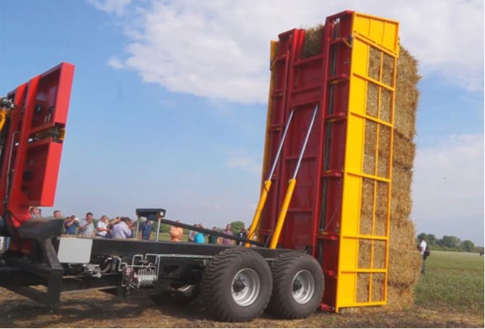
Vyložení balíky do stohu bez použití dalšího zařízení
