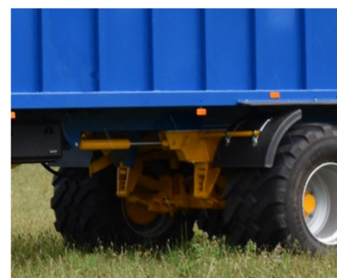
Hydraulicky posun podvozku
