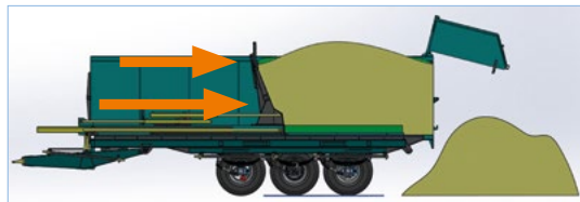
Polovina dna se pohybuje s přední stěnou
