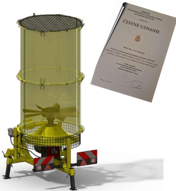
Počas jarných mrazov sú teploty v inverzných vrstvách (výška 4-30 metrov) približne o 10 °C vyššie ako na povrchu zeme. Dodávkou tohto teplého vzduchu do plodovej vrstvy nám toto patentované riešenie chráni ovocný sad pred poškodením spôsobeným mrazom.
